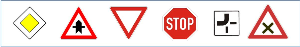
**KNOBEL 7** ist **das** Programm für die verkehrstechnische Beurteilung von Knotenpunkten ohne Lichtsignalanlage, d.h. vorfahrtgeregeltte Kreuzungen oder Einmündungen, die mit den oben dargestellten Verkehrszeichen geregelt werden. **KNOBEL 7** errechnet die Kapazität und die Verkehrsqualität.
